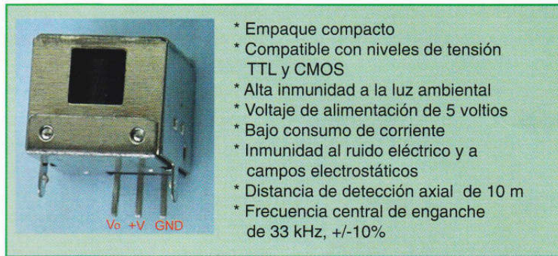
Figura 3.4. Aspecto físico, pin-out y características del módulo receptor LTM8834-2
